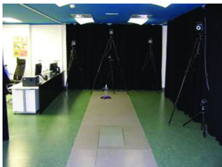
Obr. 1 Zařízení laboratoře chůze – MX kamery a DV kamery a dvě čtvercové tlakové plotny
